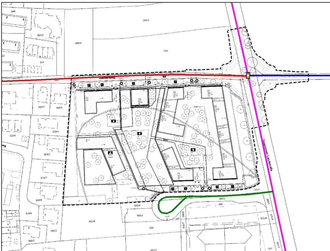
Abbildung 4: Lageplan mit Darstellung der zulässigen Höchstgeschwindigkeit (30 km/h **rot**, 50 km/h **grün**, 70 km/h **rosa**, 100 km/h **blau**)
