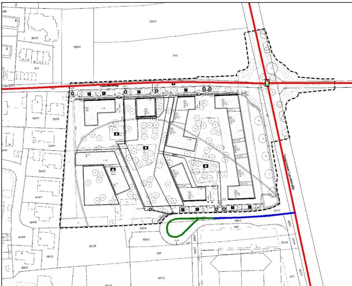
Abbildung 5: Lageplan mit Darstellung der Abschnitte unterschiedlicher Deckschichten (AC 11 grün, SMA8 blau, nicht geriffelter Gussasphalt rot)
